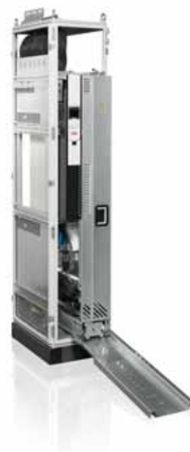
Optionales Kabelanschlussblech im Schrank montiert. Der ACS880-04 wird über eine Rampe auf Rollen bequem in den Schrank geschoben.
